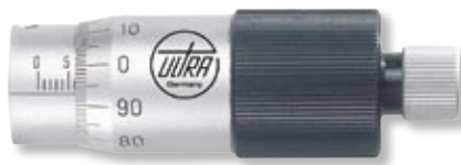
Ablesung 0,01mm, Spindelsteigung 1,0mm (100 Teilstriche auf der Trommel, Ablesung ohne Addition)
