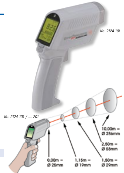
Standardoptik 60:1 : Messpunkt Ø 19mm bei 1,15m Messpunkt Ø 286mm bei 10m
